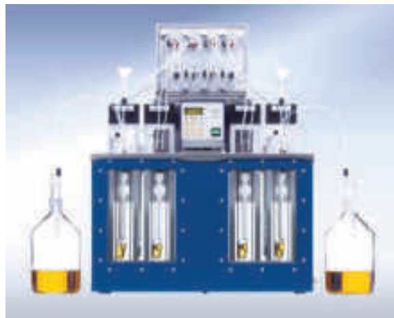
Сл. 5 - Автоматски мерен систем за капиларни вискозиметри
